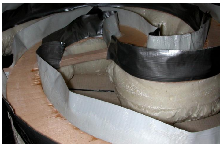
Abbildung 6.3: Profilformung des Repellers mit Bauschaum
